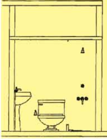
চিত্র-৪.৪.২: টয়লেটের সেকশন-এ ফিঙ্চার
