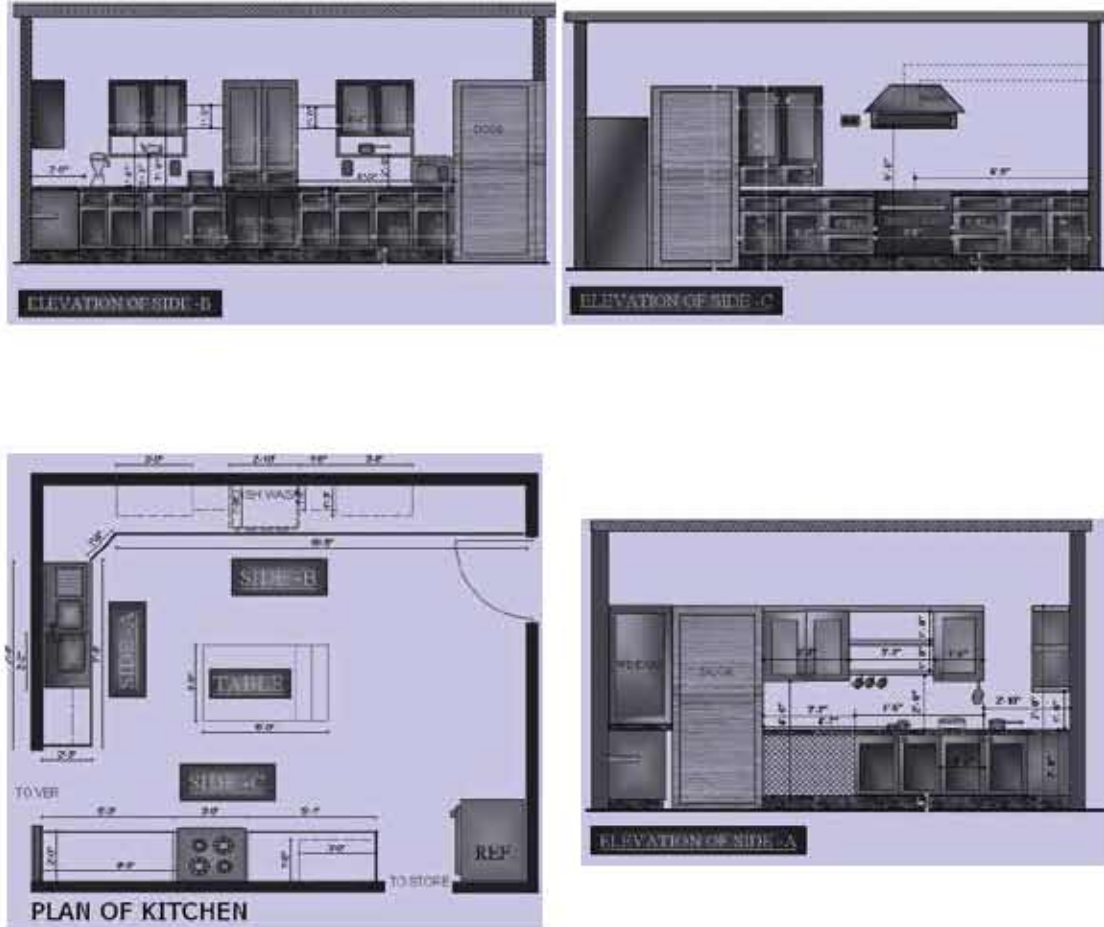
চিত্র-৬.৫.৪: একটি বড় আকারের কিচেনের ফিকচার সম্বন্ধ ও কেবিনেটের বিভিন্ন এলিভেশন
